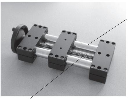
Die Führungsrohre sind in regelmäßigen Abständen und bei Bedarf mit einem dünnflüssigen Ölfilm zu benetzen.
