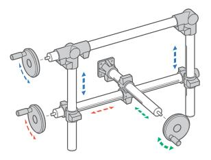
Portalaufbau mit Verstellung in Z- / X- / Y-Richtung
