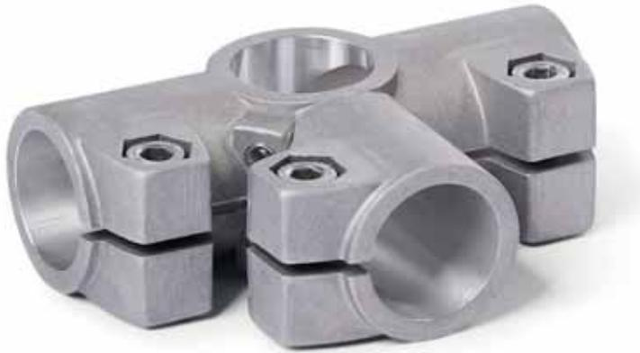
Alle Bohrungen der Klemmstellen liegen in einem Winkel von 90 Grad zueinander angeordnet. Die geschlitzten Bohrungen liegen in einer Ebene, der Bohrungsquerschnitt ohne Klemmschlitz steht senkrecht dazu. Alle Bohrungen nehmen handelsübliche Konstruktionsrohre über den gesamten Querschnitt vollflächig auf.
